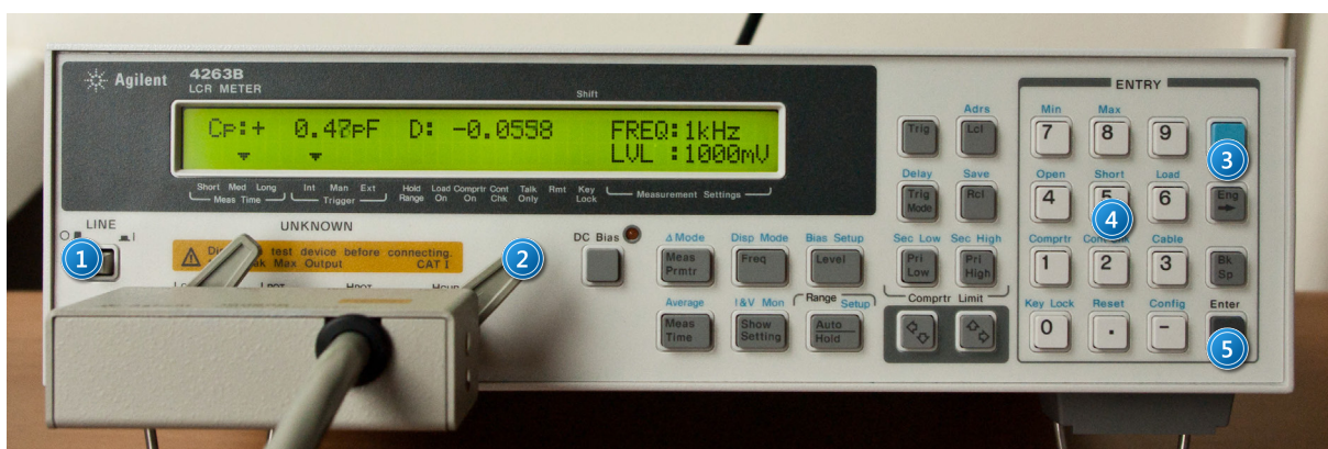
Zdjęcie 2. Widok przedniego panela mostka RLC: 1 – włącznik; 2 – zacisk przewodów; 3 – przycisk aktywacji dodatkowych funkcji; 4 – przycisk SHORT; 5 – przycisk ENTER.
