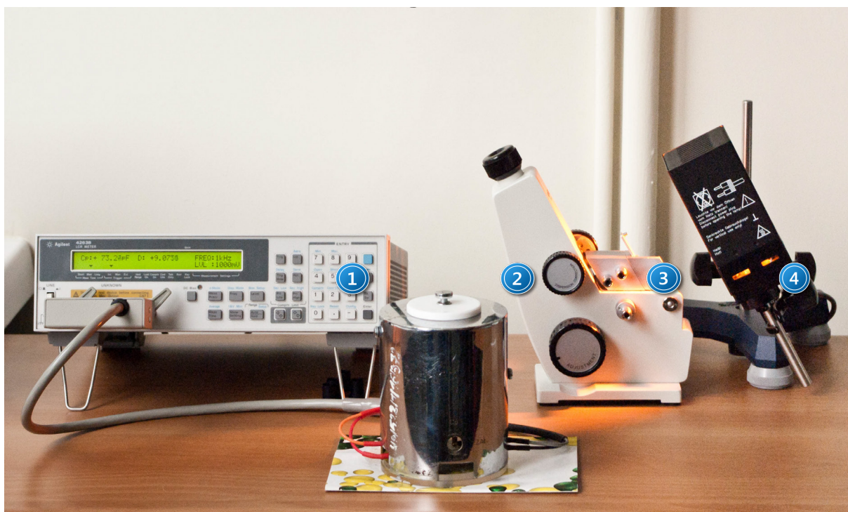
Zdjęcie 1. Stanowisko pomiarowe: 1 – mostek RLC; 2 – kondensator; 3 – refraktometr Abbe’go; 4 – lampa sodowa.
